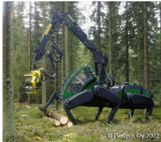
Figura 1.11. Robot hexápodo forestal ambulante [6].
