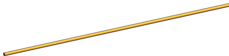
Figura 3.22. Representación de barra redonda de aluminio de 8 mm de diámetro.
