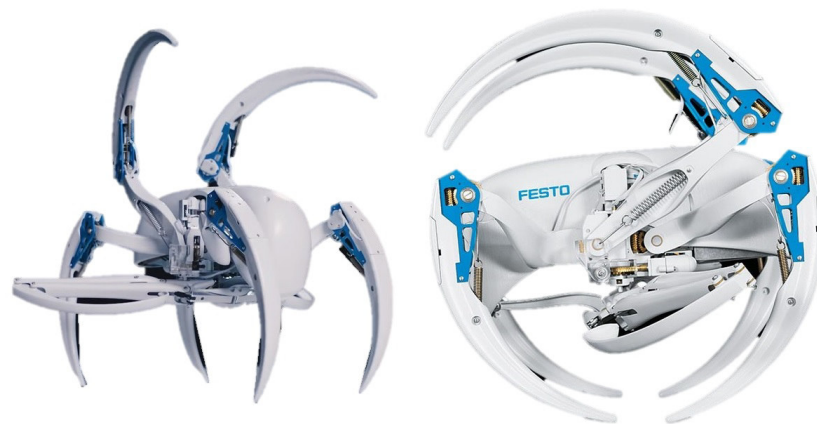
Figura 1.12. BionicWheelBot. Modo normal (izquierda), modo rodante (derecha) [18].
