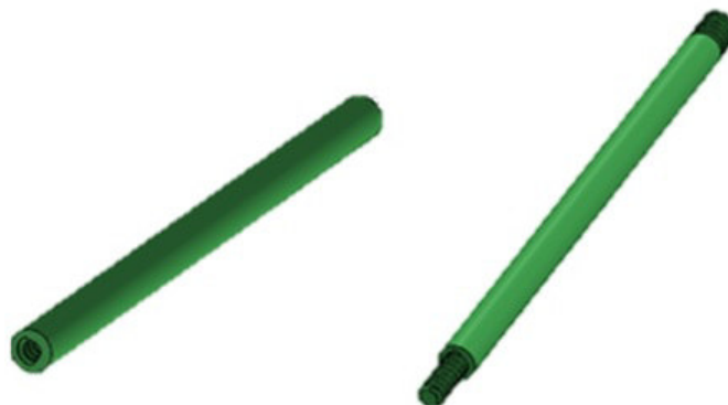
Figura 3.16. Riel para el soporte de los rodamientos lineales.
