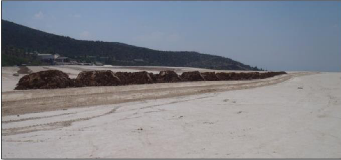
Ilustración 20.- Jales filtrados apilados sobre la plataforma del deposito
