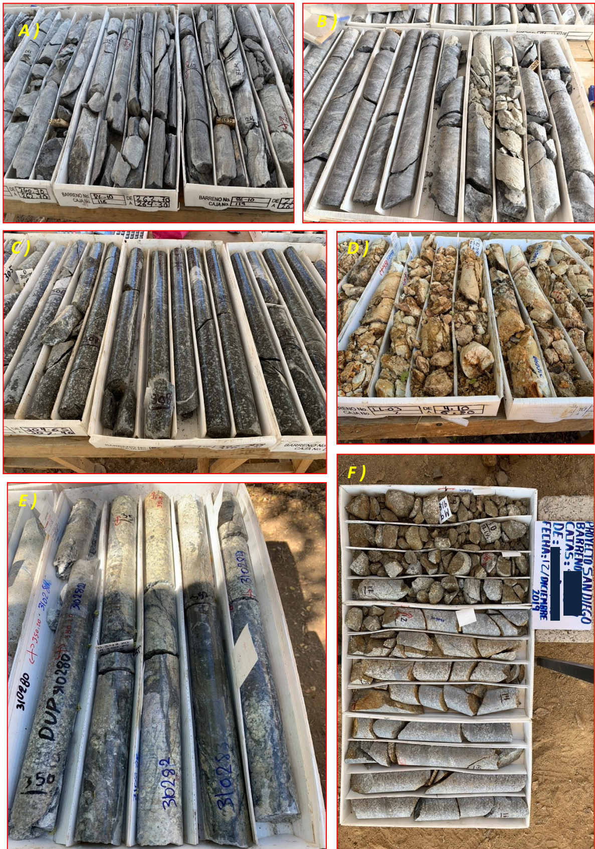
Figura 15. A) Representa la buena iluminación que tendría que existir en el lugar de logueo, además del acomodo correcto de caja de acuerdo con su metraje. B) Muestra la verificación del núcleo completo extraído. C) Núcleo medido y limpiado correctamente para un mejor análisis de su composición mineral. D) Medición de parámetros geotécnicos geotécnicos como RQD y recuperación del núcleo. E) Muestreo selecto de acuerdo con sus características minerales y desarrollo correcto del sistema QA/QC. F) Fotografía ordenada de los sondajes recuperados.
