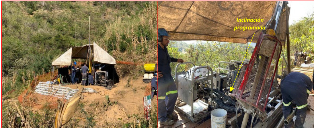
Figura 7. Inicio de la barrenación con la inclinación programada respectivamente.
