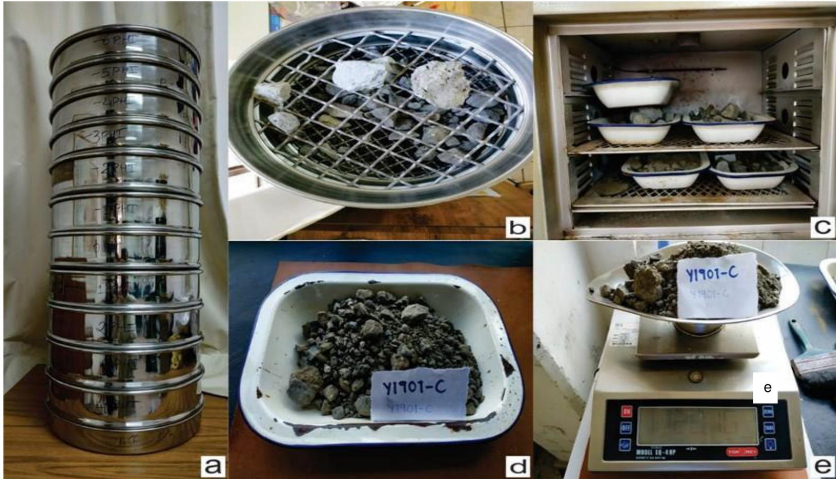
**Figura 13.** Mosaico de fotografías que muestran el procedimiento para determinar la relación granulométrica de las muestras colectadas a) columna de tamices con relación desde  $-6\phi$  a  $>4\phi$ ; b) muestra la apertura de malla para cada uno de los tamices comenzando desde  $-6\phi$ ; c) Horno de secado eléctrico; d) recipiente conteniente de muestra; e) balanza digital modelo EQ-4HP en la cual se pesaron todas las muestras recolectadas. Fotografías tomadas por J Zamacona.
