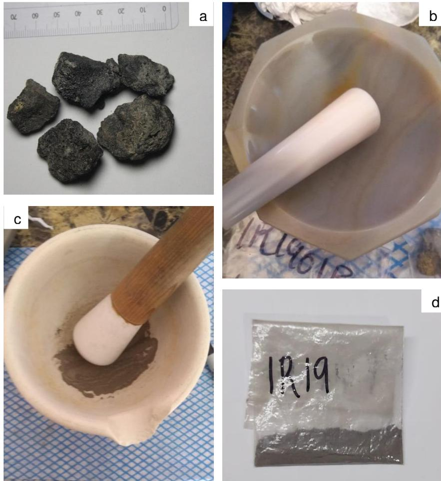
**Figura 17.** Preparación de muestras para análisis Geoquímicos. Mosaico (a) fragmento de muestra representativa de una población en interés, (b) Mortero de ágata. (c) Mortero de porcelana. (d) muestra pulverizada del tamaño de talco.
