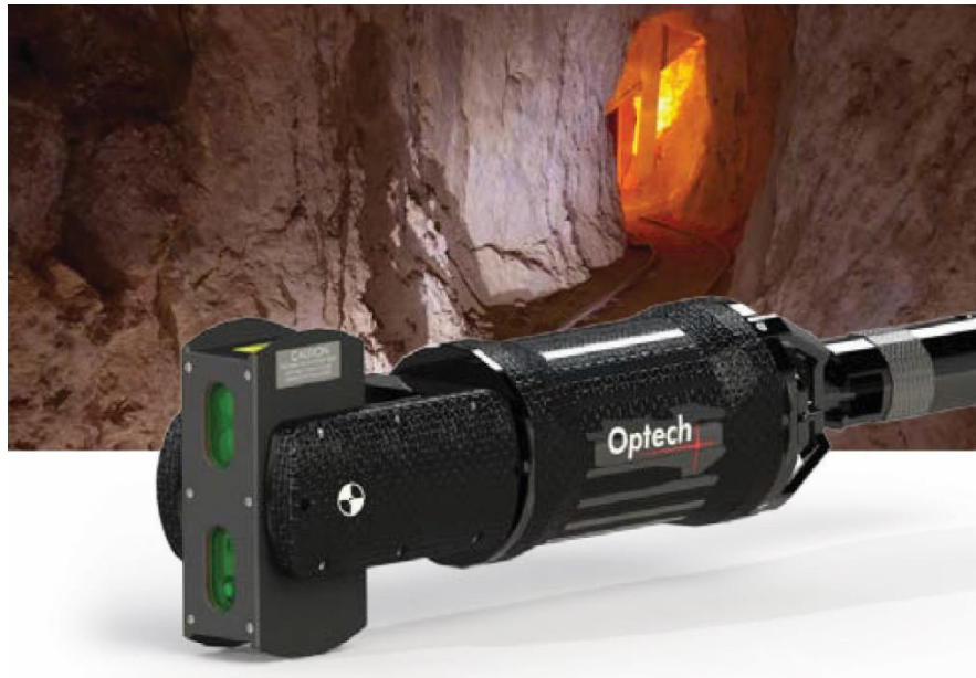
Figura 30. Imagen del equipo Optech CMS que se usa para medir cavidades sin riesgo.
