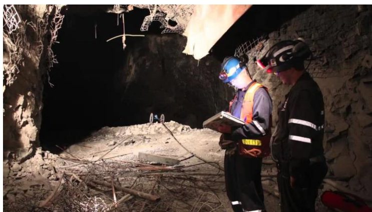
Figura 31. Operación del equipo Optech CMS. Observe que los mineros no se acercan al hueco.
