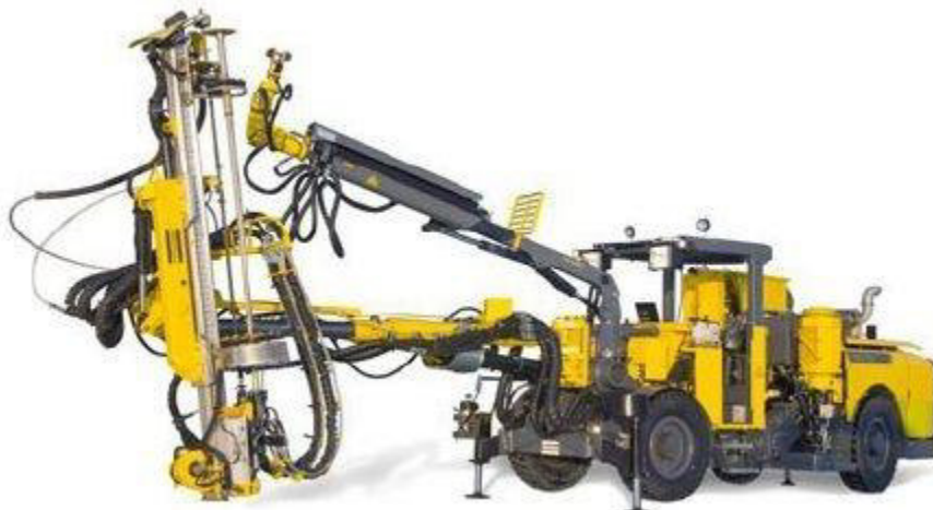
Figura 41. Equipo Simba, se usaba para hacer barrenos de hasta 50 metros.
