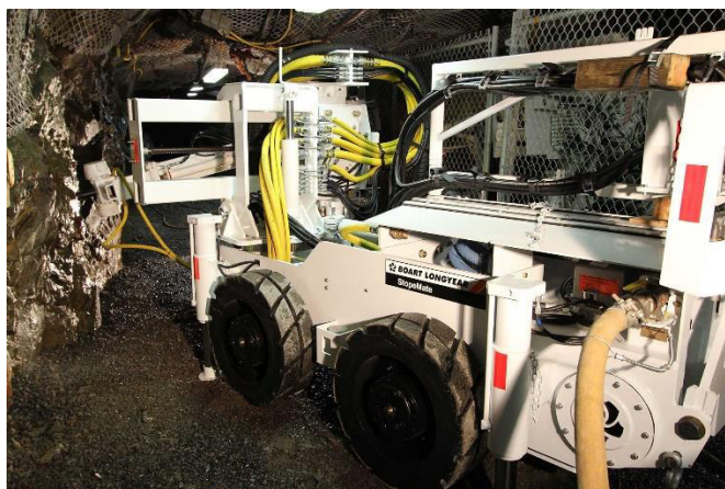
Figura 42. Stope-mate. Para barrenación larga pero usando aire.
