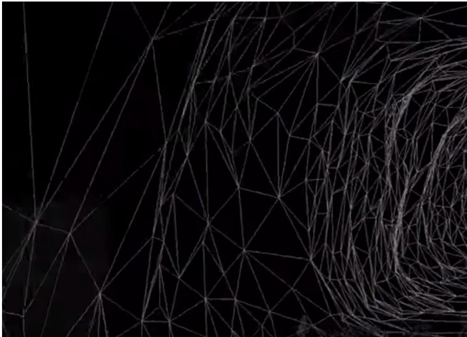
Figura 33. Vista de una frente (drift) recién hecha la voladura.
