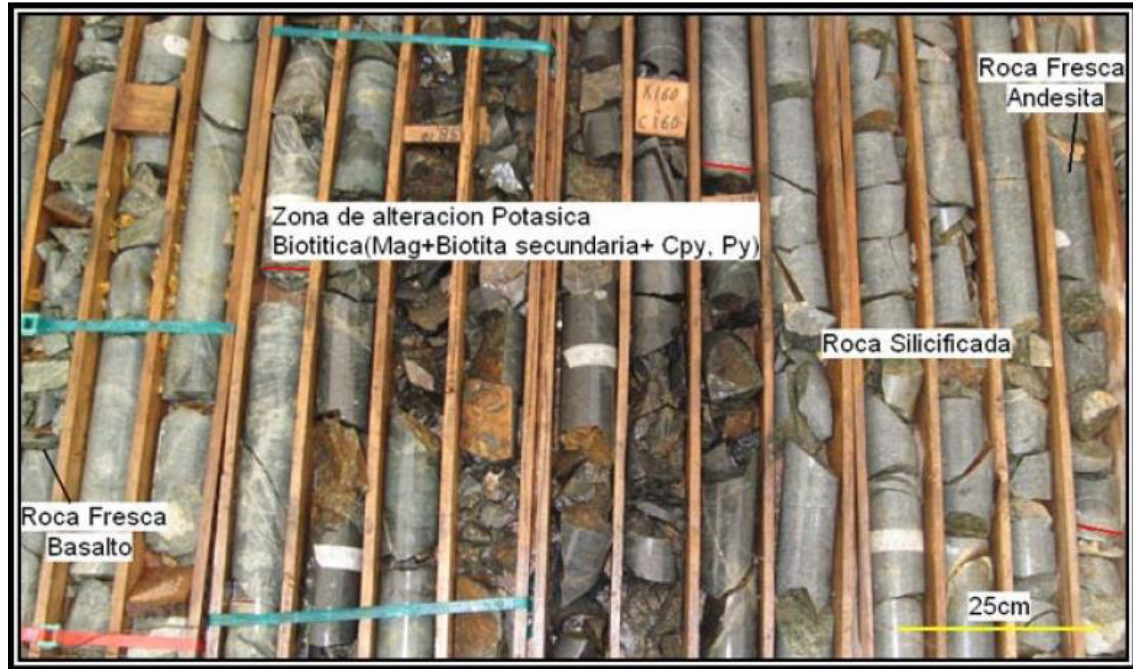
Figura 4. Ejemplo de muestra obtenida del núcleo de un barreno a diamante.
