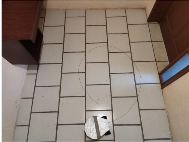
(a) Robot móvil evitando colisión en curva.
