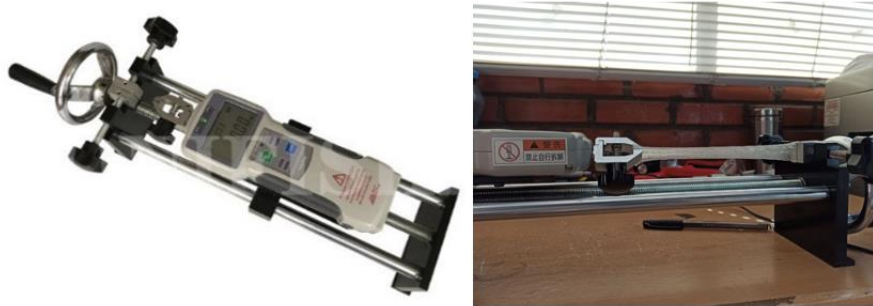
Figura 5. Medición de carga aplicada, por medio de un dinamómetro
