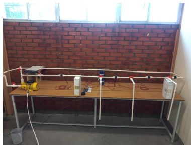
Figura 3a. Construcción del prototipo de fugas en el Laboratorio de Mecánica Aplicada, DICIVA- CIS- UG
