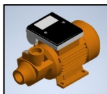
Figura 4. 1 bosquejo en 3D de bomba periférica (Ingeniero Luis Cerrada. Elaborado en "Autodesk Inventor Professional").
