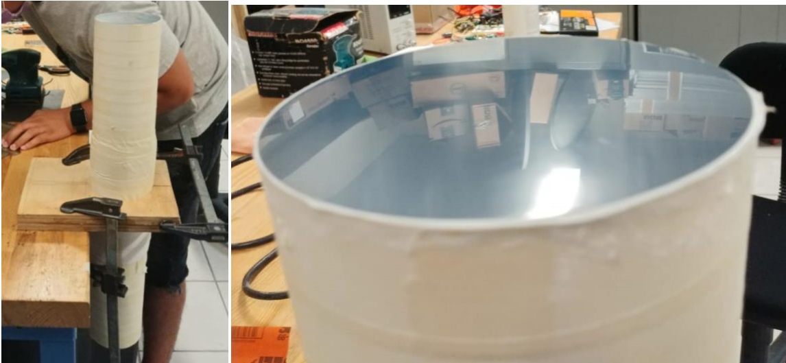
Figura 97. Barra de acrílico montada para ser pulida en sus caras circulares y a la derecha el acabado final.
