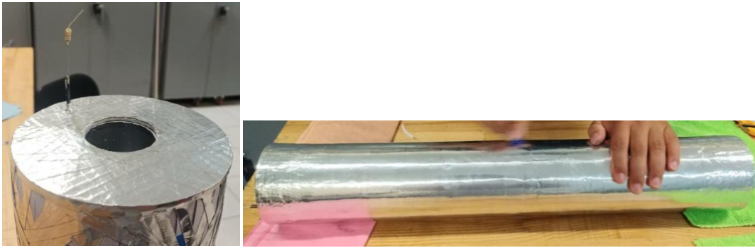
Figura 119. Caras circulares aisladas electromagnéticamente. Se puede observar cómo sobresalen 2 cables, los cuales permiten conectar el LED para calibrar los tubos fotomultiplicadores, abajo la barra acrílica aislada electromagnéticamente en toda su superficie a excepción de los orificios reservados para la ventana óptica de los tubos fotomultiplicadores.
