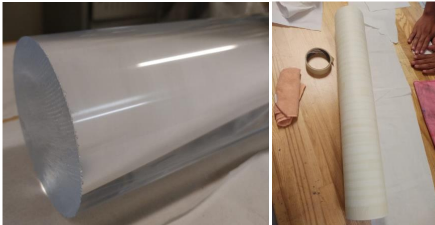
Figura 75. Barra de acrílico después de un proceso de limpieza con agua y posteriormente con el recubrimiento temporal.
