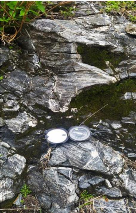
Figura 5.1.1.11. Se aprecia a la formación Esperanza, con rocas como la lutita y la filita de color negro-gris oscura (punto 10), que como se observa presenta foliación con orientación  $160^{\circ}/38^{\circ}$  SW y vetilleo de cuarzo blanco muy delgado con orientaciones como  $270^{\circ}/68^{\circ}$ N y  $78^{\circ}/77^{\circ}$  SE que cortan a la foliación, aunque hay vetillas de calcita que son paralelas con la orientación de los planos de foliación.
