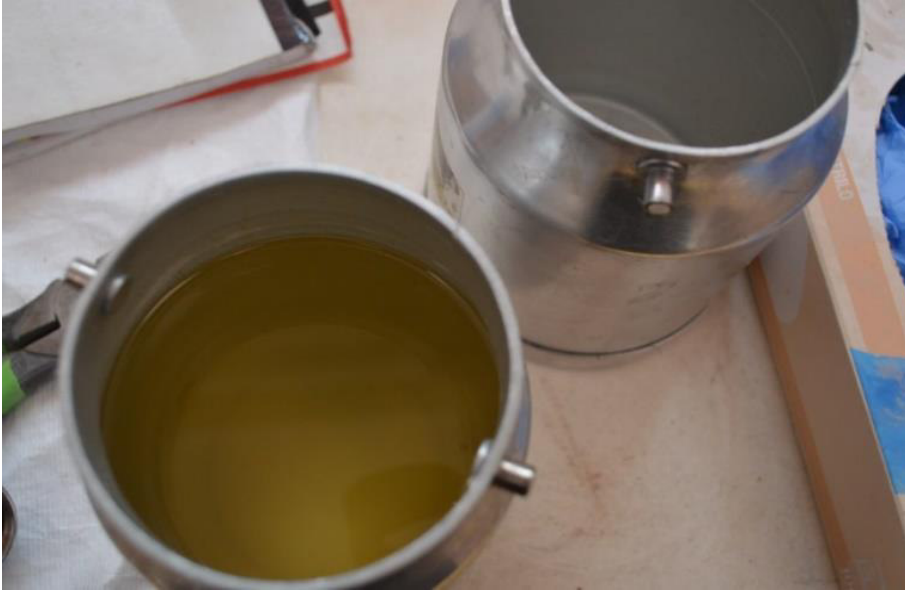
Figura 14. Registro del barniz calentado y colocado en el recipiente para después conectar a un compresor.
