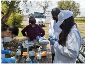
Figura 5 Análisis In situ de muestras de agua realizadas con equipos HACH. Fuente: Autor
