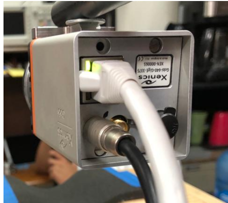
Figura 2. Conexiones de ethernet y corriente de la cámara infrarroja.
