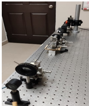
Foto 1. Experimento # 2 para el análisis de la polarización de la luz en la fibra óptica plástica
