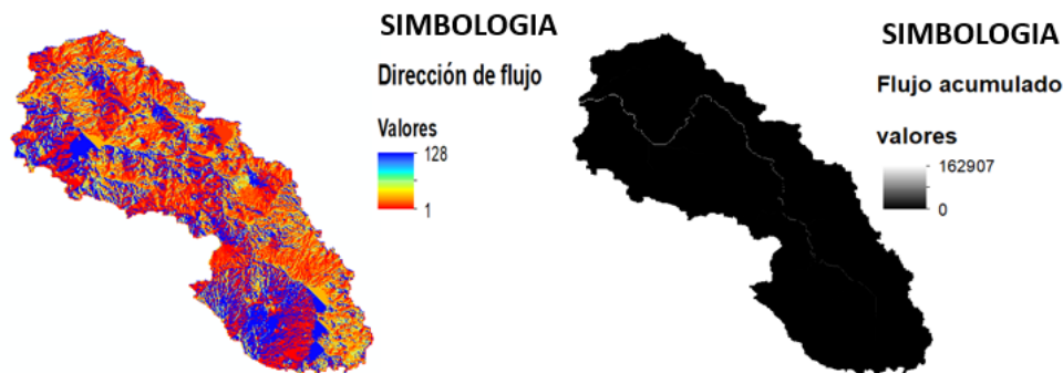
Figura 4. Mapas raster calculados para introducir las características hidromorfológicas de la cuenca: direcciones de flujo y celdas acumuladas.
