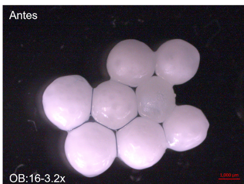
Figura 10. Micrografías de MC CMC sometidas a resistencia mecánica en una solución de Au(III) de 250 \text{ mg L}^{-1} en HCl 0.1 M: a) antes del experimento ( \Phi = 2.024 mm) y b) después del experimento ( \Phi = 2.144 mm).
