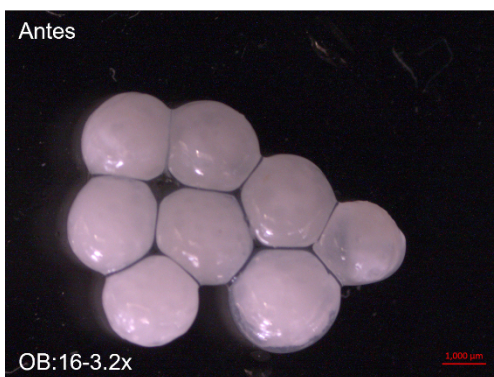
Figura 11. Micrografías de MC CMC/GA sometidas a resistencia mecánica en una solución de Au(III) de 250 \text{ mg L}^{-1} en HCl 0.1 M: a) antes del experimento ( \Phi = 1.919 mm) y b) después del experimento ( \Phi = 1.934 mm).
