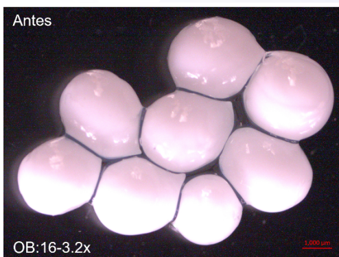
Figura 9. Micrografías de MC CMC/G sometidas a resistencia mecánica en HCl 0.1 M: a) antes del experimento ( \Phi = 2.475 mm) y b) después del experimento ( \Phi = 2.474 mm).
