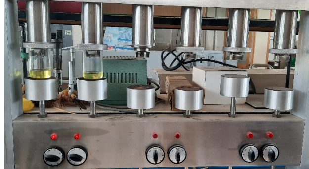
Figura 5. Determinación de contenido de aceite en el freído de alitas de pollo.
