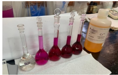
Figura 1. Determinación de Cr(VI) por espectrofotometría de UV-Visible.
