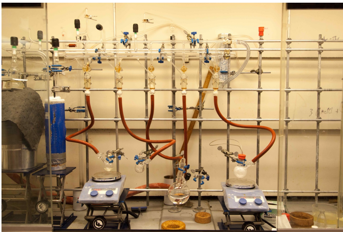
Figura 1. Línea Schlenk empleada para la síntesis de compuestos organometálicos. Fuente: Laboratorio del prof. Neil. C. Tomson, Departamento de Química, Universidad de Pennsylvania.
