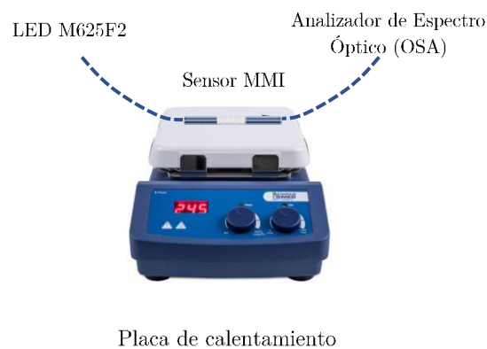
Figura 4.17 Esquema de la configuración experimental de la respuesta de temperatura del sensor.
