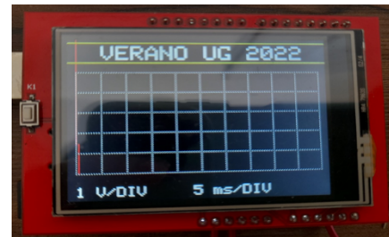
Figura 14. Exhibición de la amplificación de la señal analógica de baja amplitud y frecuencia en la pantalla
