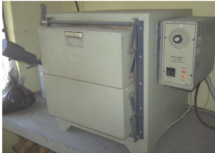
Figura 11. Horno de resistencia de 220V.
