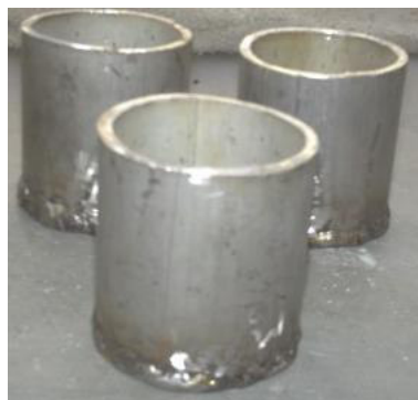
Figura 10. Recipientes de acero inoxidable dispuestos para contener las muestras a ser boruradas.
