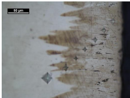
Figura 33. Perfil de microdureza de la sección transversal de la bola de acero AISI 1085. a) uso de la mezcla A3 y b) uso de la mezcla B1.
