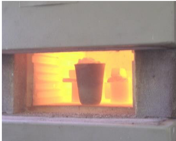
Figura 9. Bórax expandido en crisol a 700 °C.
