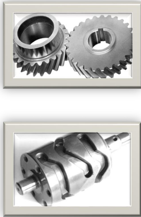
Figura 1. Piezas con su superficie endurecida con una capa de boruros.
