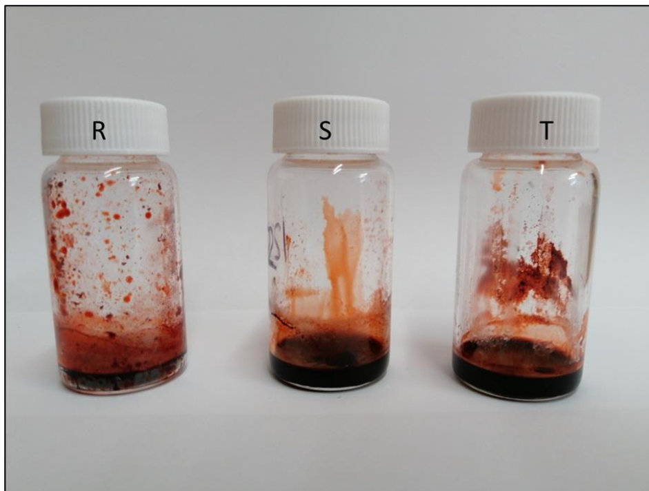
Figura A7. Polímeros de LLA (PLLA) organocatalizados por Ácido Carmínico (Muestras R, S y T, Tabla 4.8).
