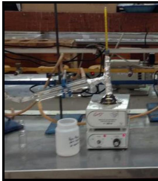
**Figura 4.1.** Sistema de reacción, para la disolución parcial de la matriz sílicea del mineral.
