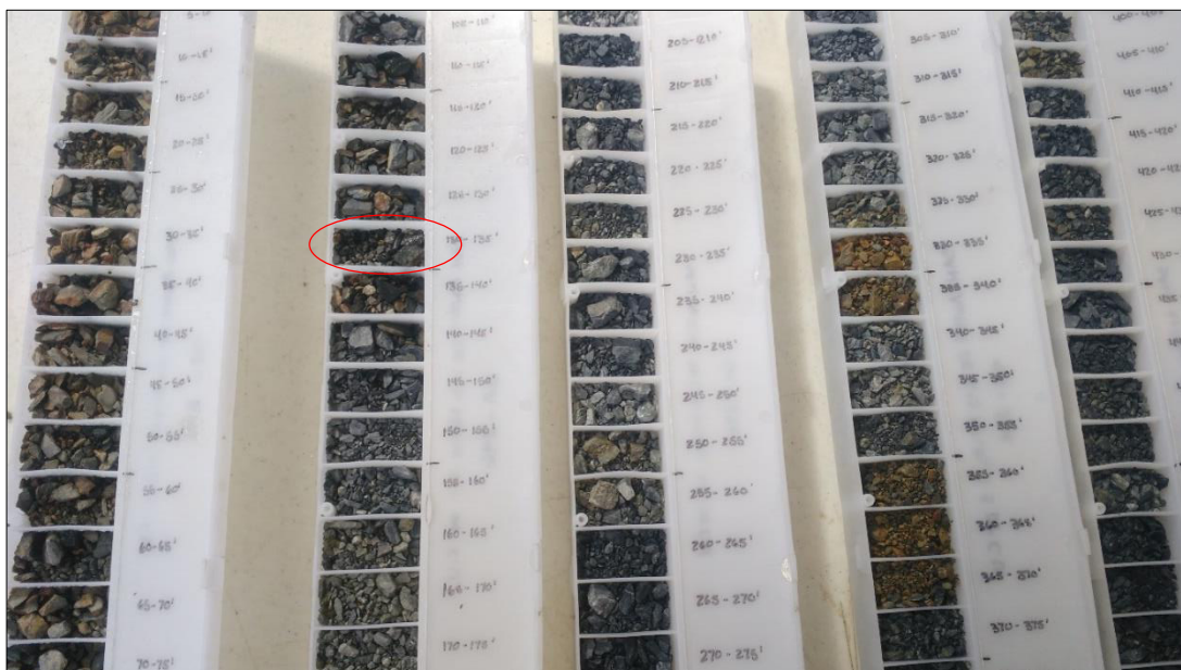
Figura 24. Barreno de circulación inversa donde se muestra puntual zona de sulfuros masivos.
