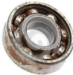
**Figura 3.26:** La figura muestra un rodamiento dañado por falta de lubricación.
