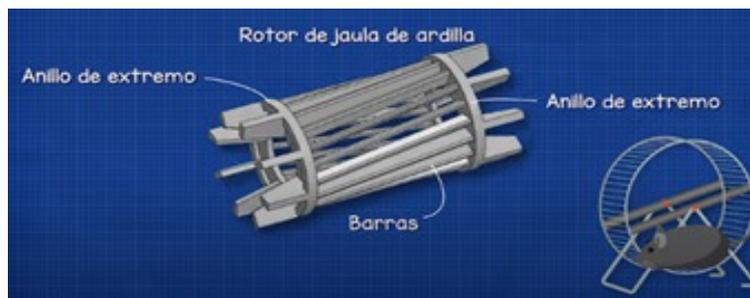
**Figura 3.22:** Rotor tipo jaula de ardilla.
