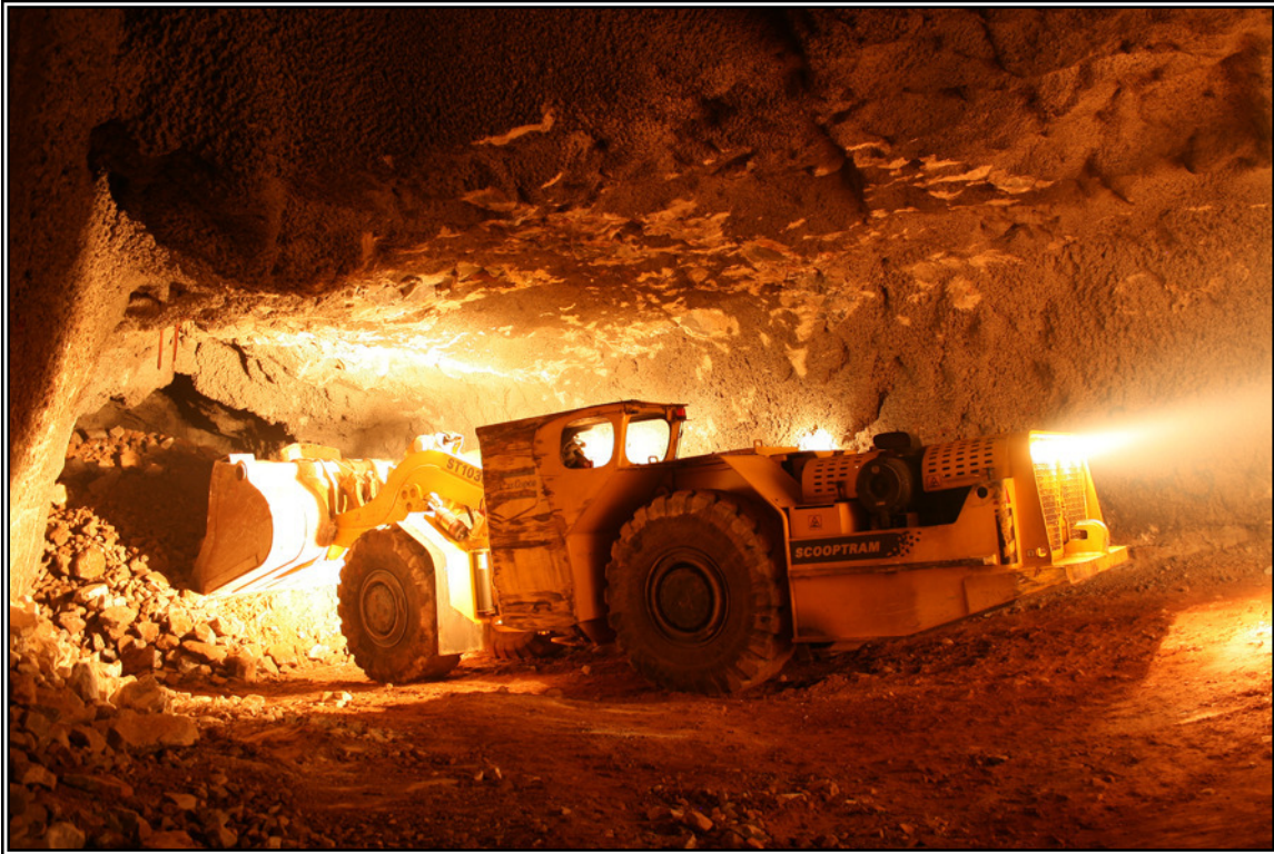
Fotografía 5.- Rezagado de rebaje con scoop tram
