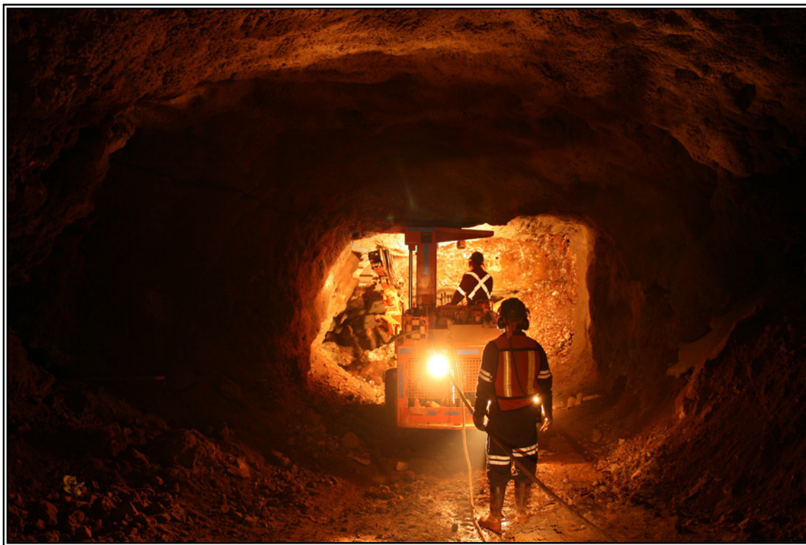
Fotografía 4.-Barrenación de rebajes con jumbo
