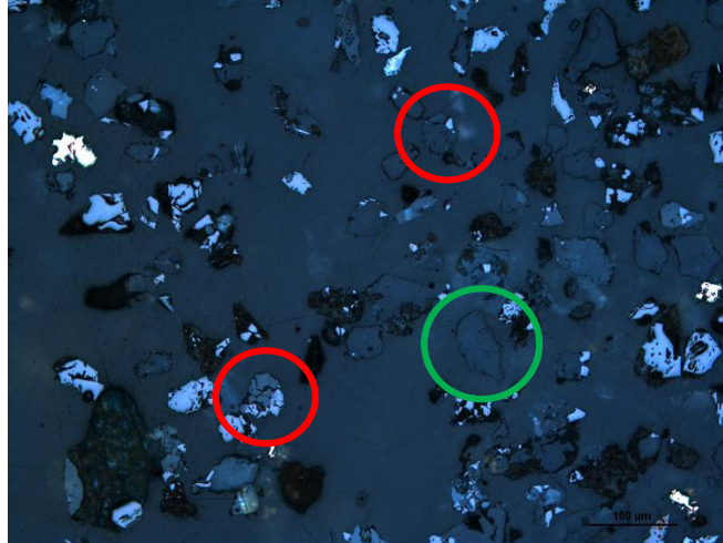
Figura C2-1. Fotomicrografía de la fracción +37 \mu\text{m} de las colas de flotación de sílice en microscopio de luz polarizada con nicoles paralelos. Partículas de sílice (fase azul oscuro), magnetita (fase azul clara) y pirita (fase amarillo brillante). El círculo verde muestra una partícula de silicato libre, los círculos rojos muestran partículas asociadas de sílice y magnetita.
