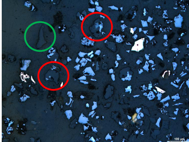
Figura C3-1. Fotomicrografía de la fracción -37+20 \mu\text{m} de las colas de flotación de sílice en microscopio de luz polarizada con nicóles paralelos. Partículas de sílice (fase azul oscuro), magnetita (fase azul clara) y pirita (fase amarillo brillante). El círculo verde muestra una partícula de silicato libre, los círculos rojos muestran partículas asociadas de sílice y magnetita.
