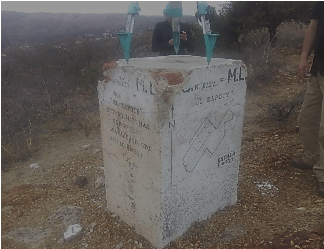
Figura 6.9. Mojonera que identifica en Campo el Punto de Partida del Lote minero “El Zapote”.
