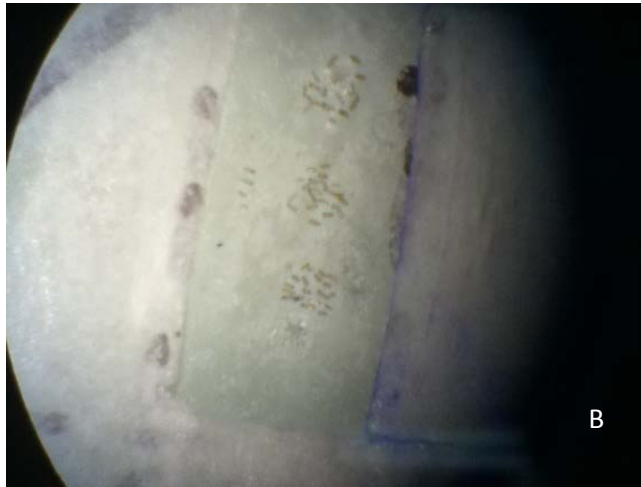
Figura 8 (Continuación). Montado de circones. B) Muestra con más de 40 circones vista a través del microscopio binocular.
