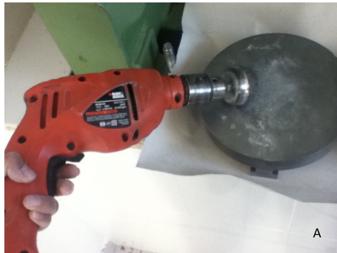
Figura 3. Herramientas utilizadas en la trituración de roca A) Uso de taladro para limpiar las placas de la trituradora.
