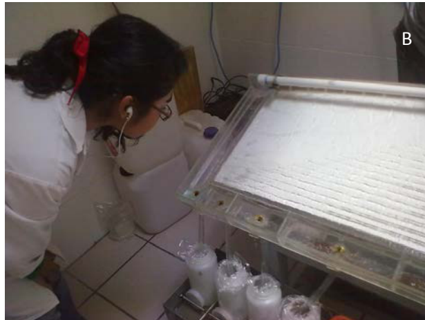
Figura 7. Mesa Wilfley utilizada para la separación de circones. A) Mesa Wilfley antes de iniciar el separado. B) Mesa Wilfley en uso.
