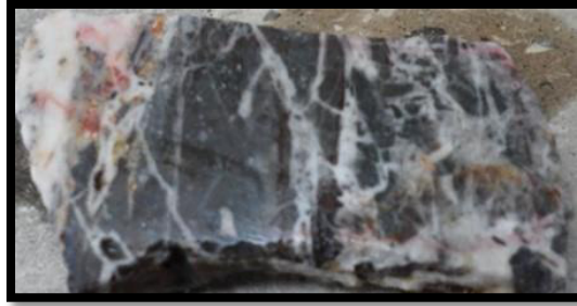
Figura 13: Muestra de veta textura tipo stockwork
