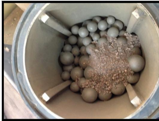
**Figura 4.3.-** Molino de bolas utilizado para los estudios de reducción de tamaño de partícula.
