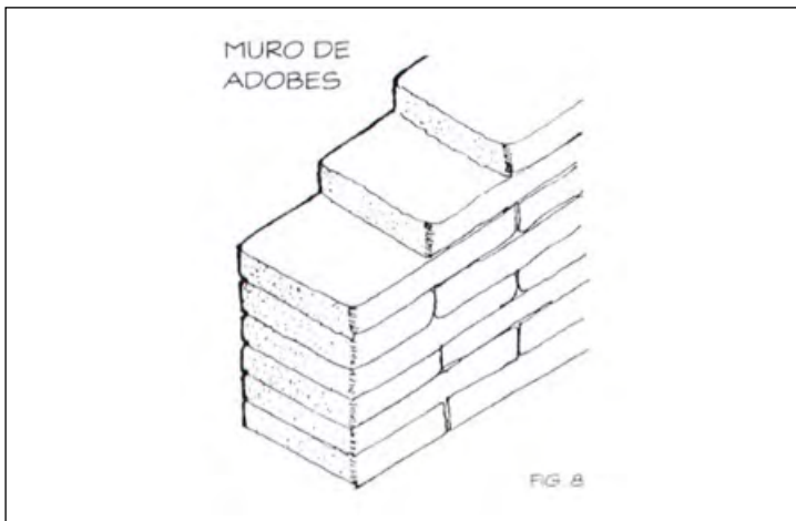
Imagen 116. Muro de adobe. Fuente: L. Torres Garibay (1999).
