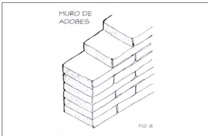
Imagen 116. Muro de adobe. Fuente: L. Torres Garibay (1999).
