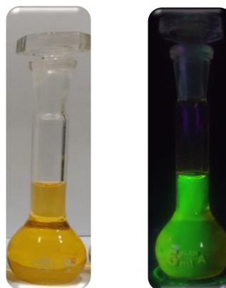
Figura 13. BODIPY 1f en solución bajo luz blanca e irradiación de luz UV, 365 nm.
