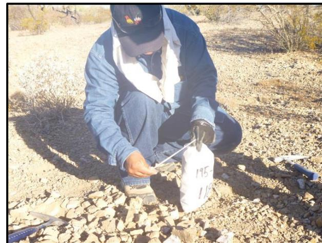
**Figura 8. Proceso de toma de muestra. A) Ubicación de la Veta-Vetilla. B) Marcado de Bolsa. C) muestreo de esquirla. D) colocación de talonario. E) Amarrado de bolsa.**
