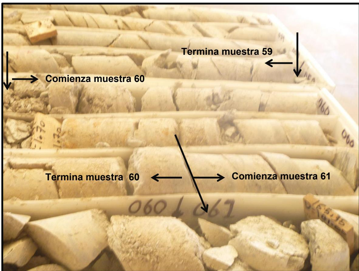
**Figura 25. Marcado de muestras cada 2 metros sobre el barreno**
