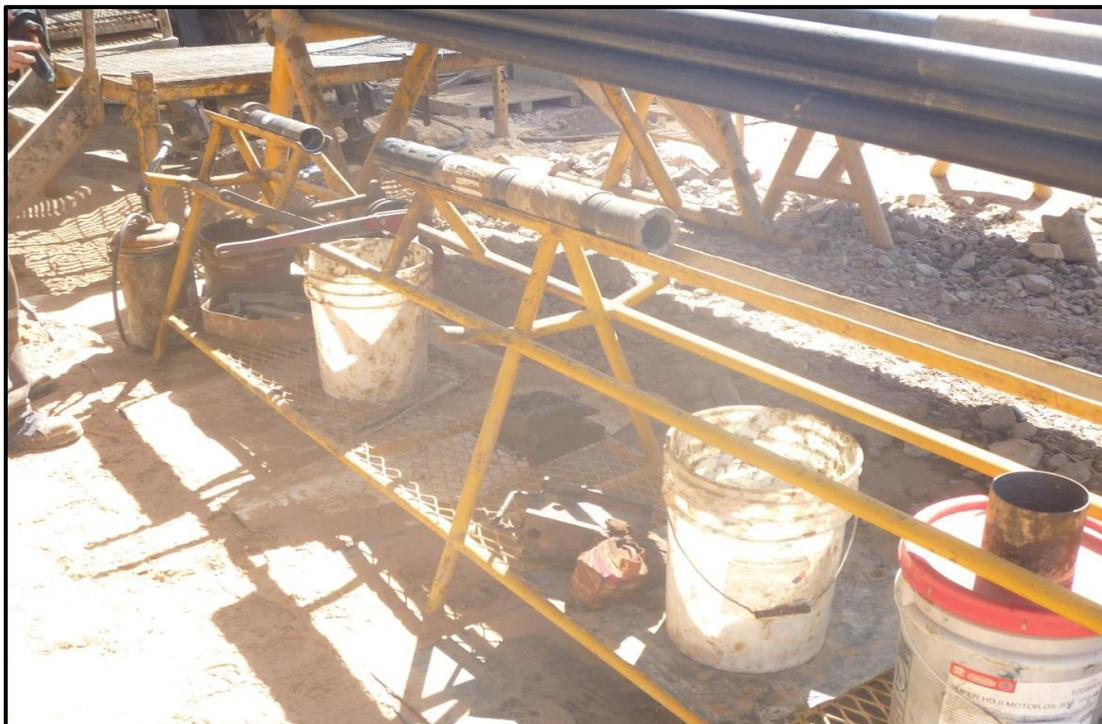
Figura 17. Barra montadora de testigo.
