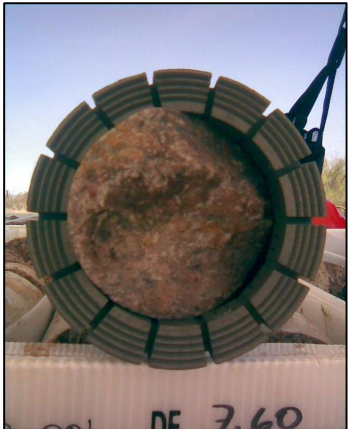
**Figura 15. Corona de Diamante con Testigo HQ**
