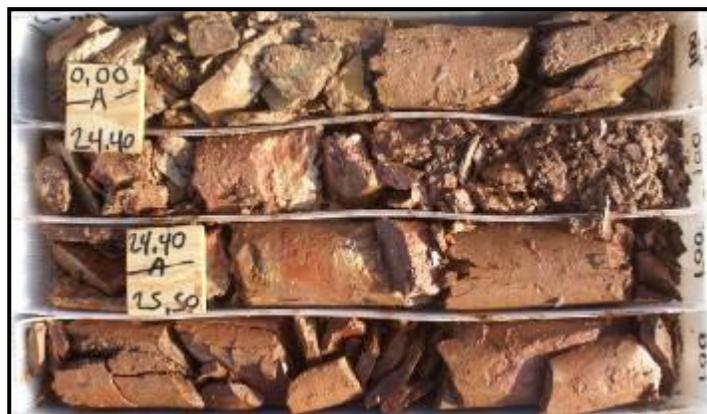
**Figura 22. Zonas de gouge en los barrenos**
