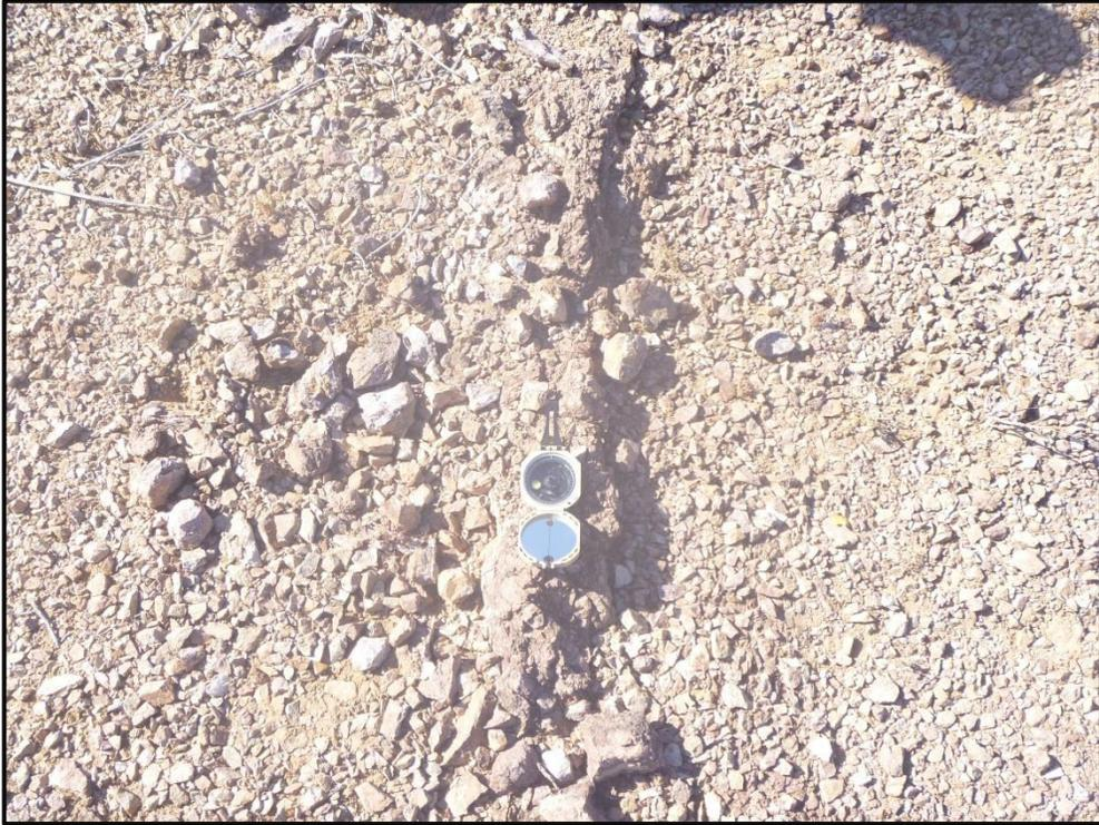
**Figura 5. Toma de rumbo y echado de la veta a muestrear**
