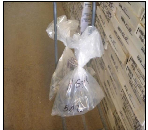
**Figura 27. Muestreo de núcleo cortado y embolsado para ser llevado a laboratorio. El resto sé que queda cómo testigo y se almacena en bodegas.**
