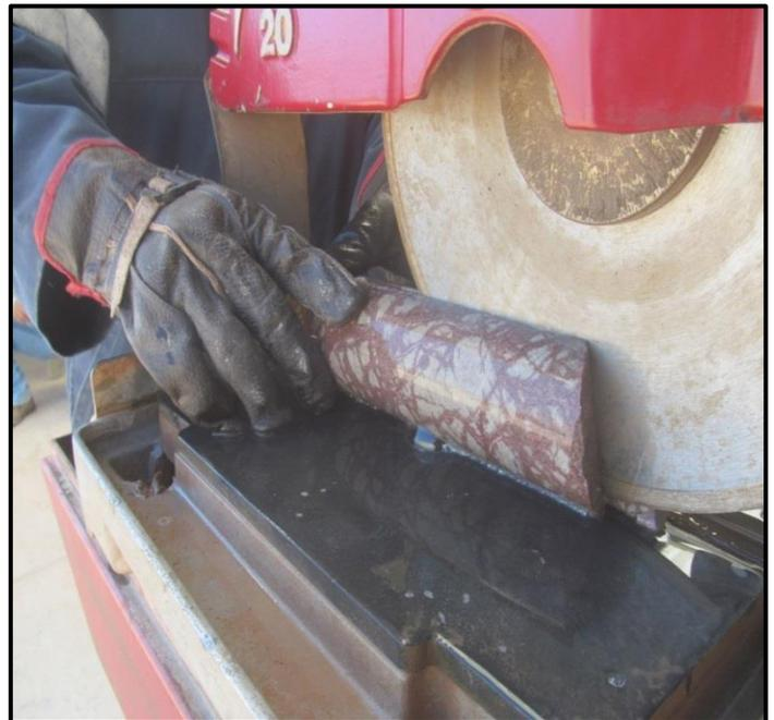
**Figura 26. Corte de núcleo para la obtención de muestra.**
