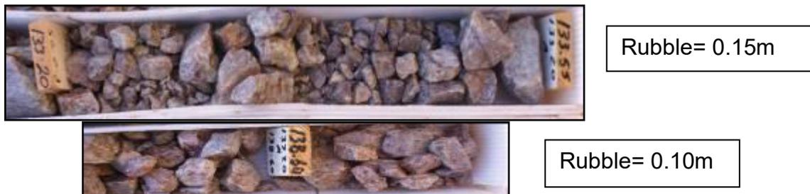
**Figura 21. Zonas de rubble en los barrenos**
