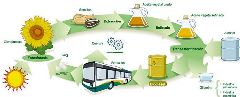
Figura 3.5 Ciclo de producción de biodiesel a partir de semillas (Meher et al., 2006)
