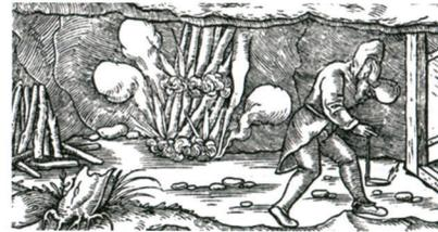
Figura 14. La Técnica del Fuego, según grabado de "De Re Metallica".
