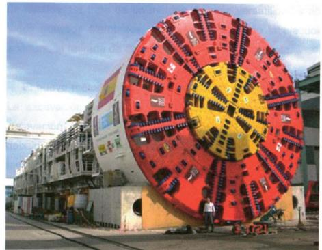
Figura 15. Maquina Tuneladora (TBM)
