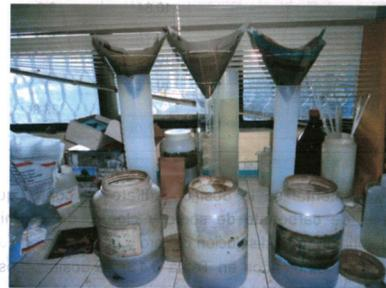
Figura 3.9.- Equipo de lixiviación y lavado de pulpa
