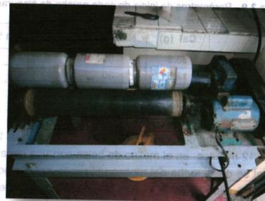
Figura 3.5.- Equipo-mecanismo de agitación para pruebas de lixiviación dinámicas.
