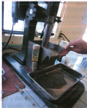
**Figura 3.4.-** Fotografía mostrando el proceso de pruebas de cinética de flotación, colección de concentrado.
