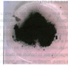
Figura 3.12.- Precipitado obtenido después de la cementación con cobre.
