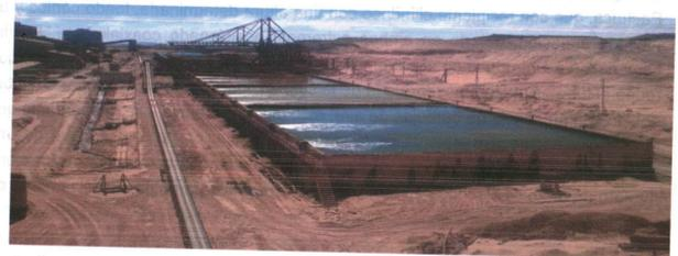
Figura 2.3.- Lixiviación por pilas.
