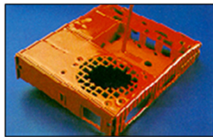
Figura 1.11: Moldeo con defecto de disparo corto.
