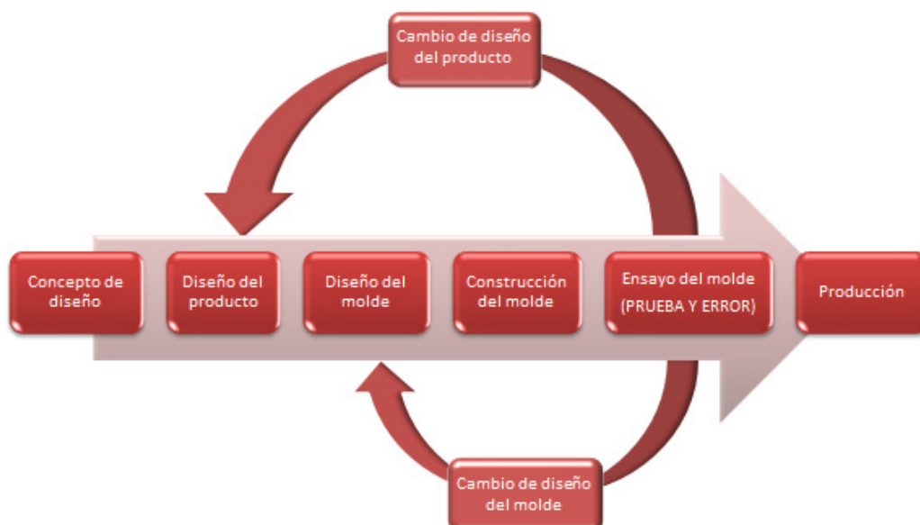
Figura 2.1: Proceso convencional de producción por inyección.
