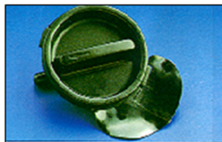
Figura 1.12: Moldeo con defecto de rebaba.
