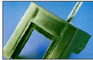
Figura 1.14: Moldeo con defecto de hundimiento.
