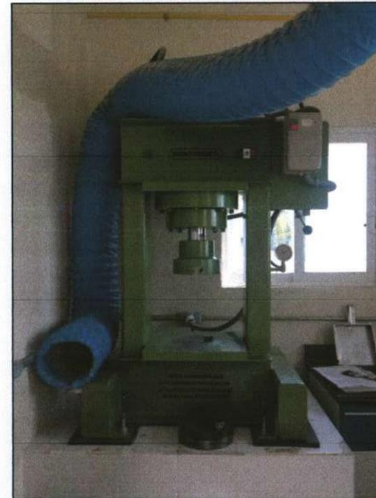
Figura 7. Prensa hidráulica
