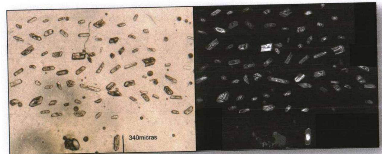
**Figura 42** Zircones de la muestra EA0 4. La fotografía de la izquierda fue tomada con un microscopio petrográfico con luz plan y objetivo 5x. A la derecha la imagen de catodoluminiscencia.
