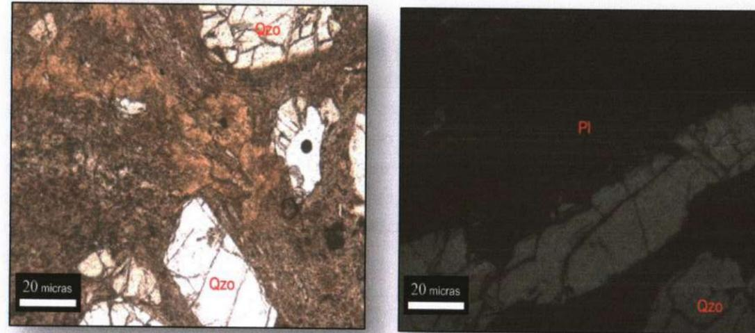
**En la Fig. 20** Fotografía tomada con objetivo 4x, con luz plana. Se aprecian fenocristales de cuarzo fracturados, microlitos de cuarzo y plagioclasa, rodeados de espículas de vidrio en forma alargada con textura de flujo.
