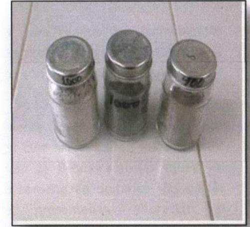
**Figura 5.** Abrasivos de carbonato de silicio
