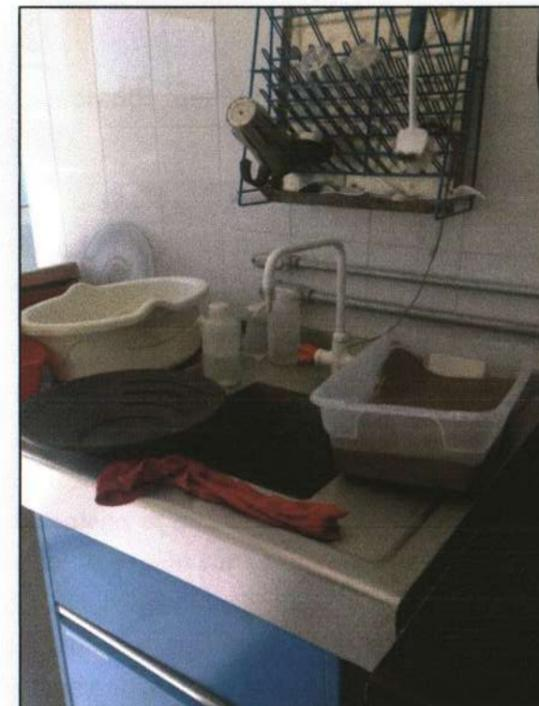
**Figura 8.** Lavadero y batea, para separación de minerales pesados.
