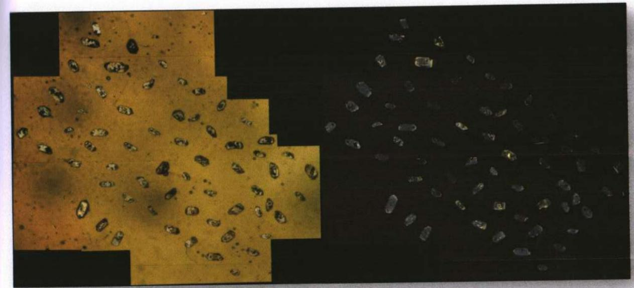
Figura 56. Zircons de la muestra EA 141. La fotografía de la izquierda fue tomada con un microscopio petrográfico con luz plana y objetivo 5x. A la derecha la imagen de catodoluminiscencia.
