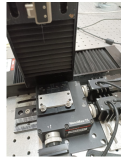
(d) En la siguiente imagen se muestra el diseño del interferómetro simple Fabry-Pérot donde la segunda interfaz es vidrio perteneciente a un portaobjetos de laboratorio.
