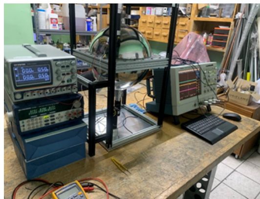
Figura 10. Detector a base de una esfera metálica.
