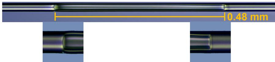
Figura 6.1 Vista lateral del dispositivo fabricado y la sección de empalme entre la MMF y la CHCF.
