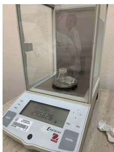
Figura 1. Equipo utilizado para la determinación de la porosidad del residuo de café.
