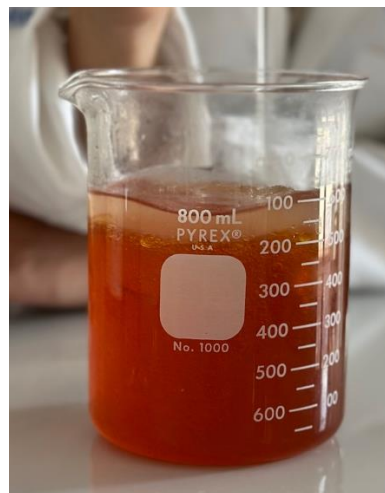
Figura 6. Agregado y disolución de la sosa caustica.
