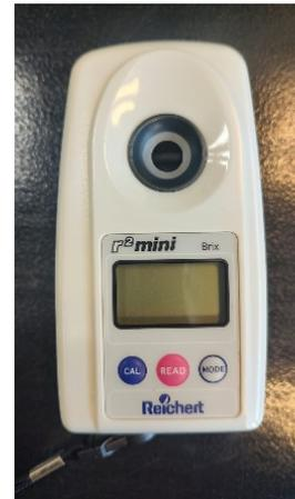
Figura 5. Refractómetro digital
