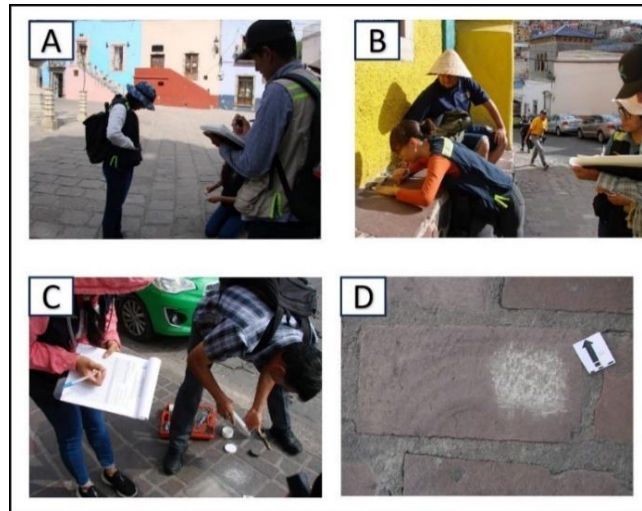
Figura 5. Recolección de los distintos datos de campo. A) Recolección de datos en la plaza San Roque. B) Toma de medidas y orientación de las losas en la calle Mendizábal. C) Llenado de formato en prueba de resistencia realizada con el martillo Schmidt. D) Marcado de plantilla (retícula de 6X8 cm a cada 2 cm) de puntos en los que se aplicaron veinte impactos con el martillo Schmidt.
