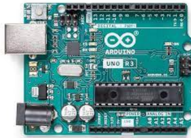
Figura 3. Tarjeta madre Arduino UNO
