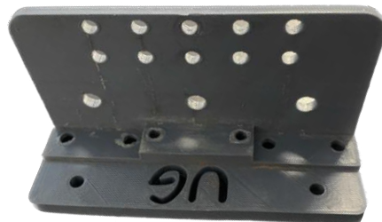
Figura 15 Pieza de acoplamiento para sensores y componentes material: PLA, Ilustración Propia.
