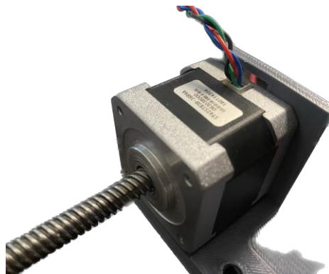
Figura 9 Motor a pasos Nema 17 con tornillo sin fin SY42STH38, Ilustración Propia.
