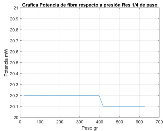
Figura 61 Grafica de prueba con fibra óptica plástica y Prototipo Mecánico Resolución 1/4 de paso. Ilustración Propia.
