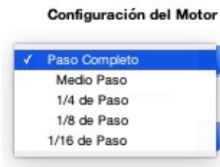
Figura 26 Configuración de la resolución de motor a pasos. Ilustración Propia.
