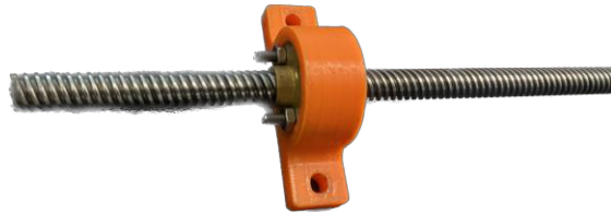
Figura 10 Chumacera para tornillo sin fin con perforaciones para adaptación, Ilustración Propia.
