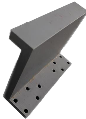
Figura 16 Pieza móvil del prototipo Material: PLA, Ilustración Propia.
