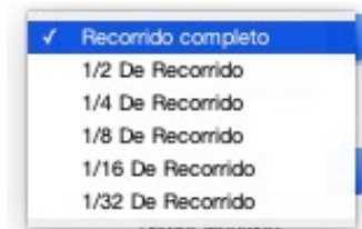
Figura 28 Recorridos por defecto para funcionamiento del motor a pasos. Ilustración Propia.
